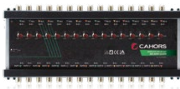
Ampli variable 16 entrées / 16 sorties avec atténuateurs 0-20 dB
